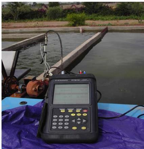
Figure 6B : Dispositifs de mesure du débit et de la pression sur le circuit hydraulique de la roue à aubes
