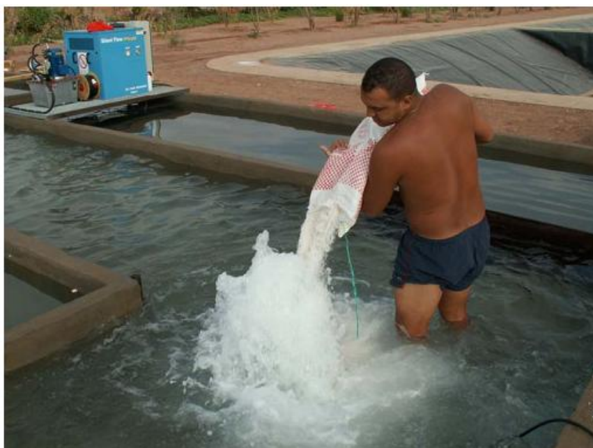
Figure 5 : Injection de sel lors d'un essai de traçage avec la roue à aubes.
