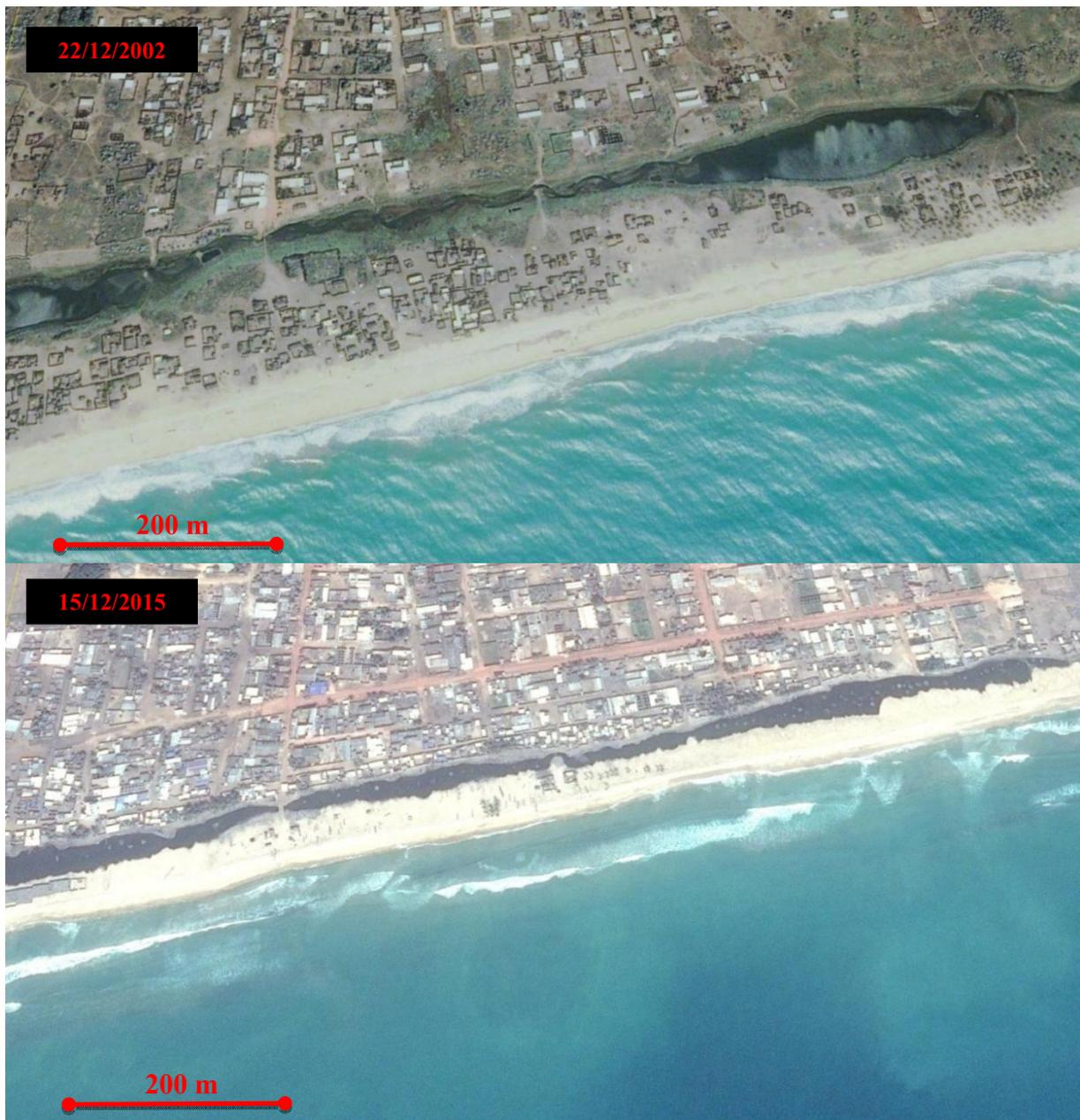
**Figure 7** : Evolution récente du trait de côte (2002-2015) dans l'extrême ouest du Bénin, à la frontière avec le Togo [Fig.3, PK 50].
