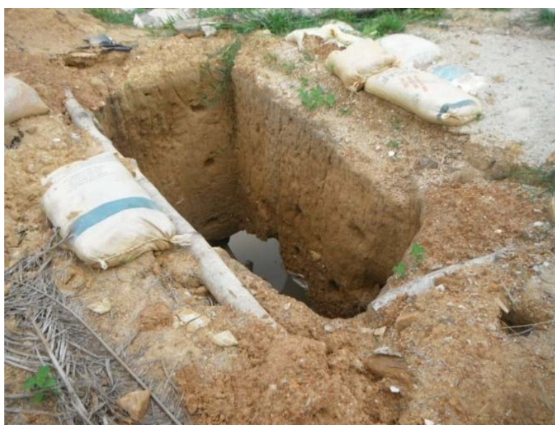
Figure 9 : Fosses créées par les orpailleurs dans les mines artisanales à Hiré
