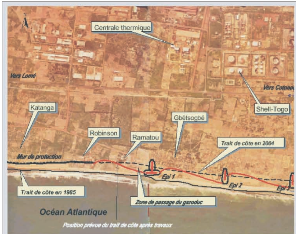
Fig. 11: Schématisation du système de protection inadapté pour le secteur de Katanga - Gbetsogbé
